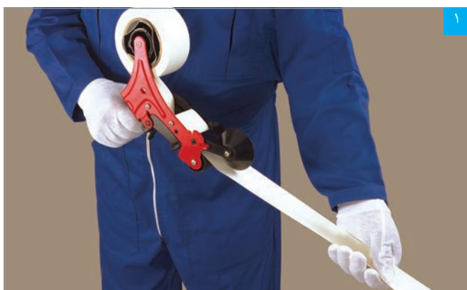
خم کردن نوار درزگیر با دستگاه تازن
