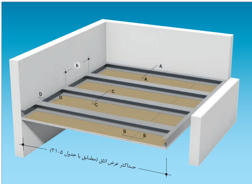
اتصال سازه تراز باربر به دیوار خشک (برش D-D)
